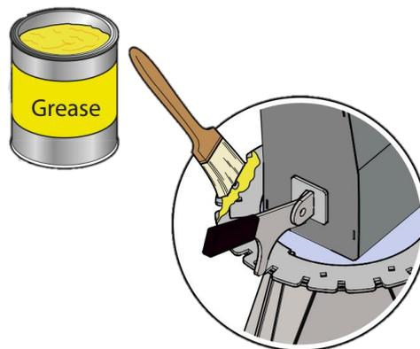
Abb. 9-16 – Schmierung des Auswurftrichterflanschs
